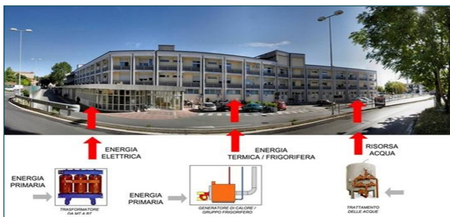
Figura 3: Schema dei flussi di energia caratteristici dell'ospedale (Ospedale Franchini di Santarcangelo di Romagna)
